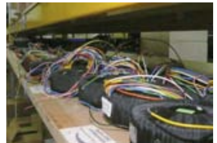
Габаритная мощность силовых трансформаторов в усилителях Naim выбирается почти с десятикратным запасом. Изготавливаются они в Словении по очень жёстким спецификациям
