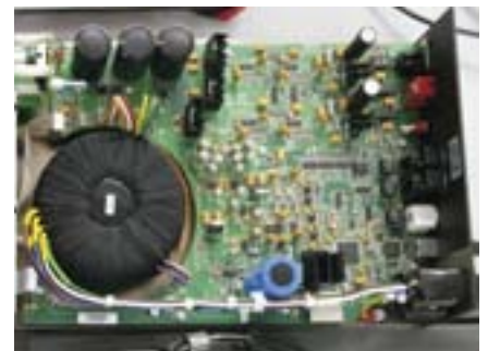
Габаритная мощность силовых трансформаторов в усилителях Naim выбирается почти с десятикратным запасом. Изготавливаются они в Словении по очень жёстким спецификациям
