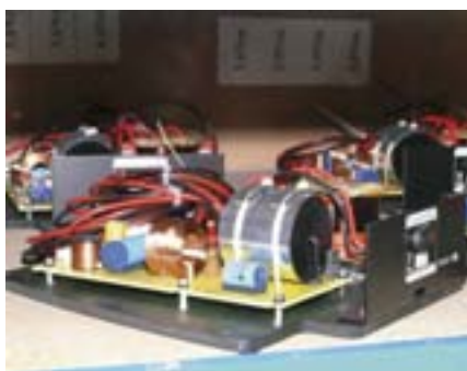
Кроссовер от акустической системы Ovator S-600. Никаких электролитических конденсаторов, катушки только «на воздухе», мощные металлопленочные резисторы
