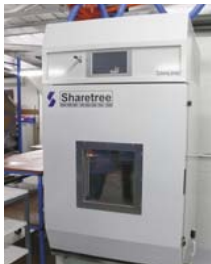
Naim поставляет компоненты в 47 стран, в т.ч. регионы с тропическим климатом. В этом шкафу проводятся испытания техники при повышенной температуре и 100% влажности
