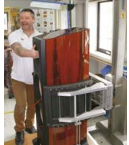
Сборка акустической системы. При массе колонки 60 кг без гидравлических захватов не обойтись даже тренированному специалисту
