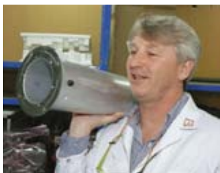
Плоский фирменный драйвер BMR (The Balanced Mode Radiator) работает от 200 Гц и выше, обеспечивая когерентное излучение и широкую диаграмму направленности. Для развязки от басовых динамиков устанавливается в алюминиевой трубе, которая также оптимизирует тыловую нагрузку мембраны
