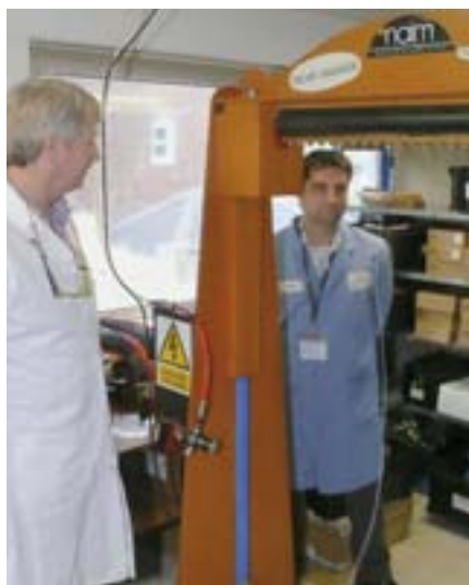
В любом кабеле после сборки и распайки разъёмов остаются механические напряжения. Уникальная установка Spaic Shaker предназначена для снятия таких стрессов
