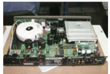
Универсальная система Unilite, вид изнутри. Опять же обратите внимание на размер сетевого трансформатора
