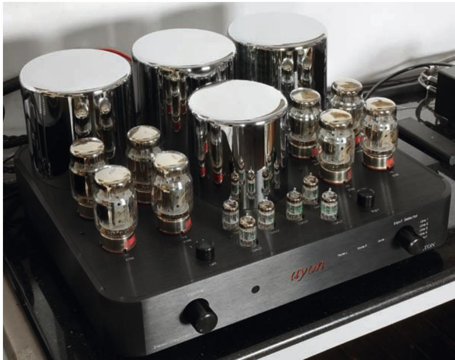
рование нагрузки, а «хвост» гармоник становится короче. Входные каскады и драйвер построены на двойных триодах 12AU7, коих по три штуки в каждом канале. Все лампы, включая выходные, тщательно подобраны. Выпрямитель построен на сильноточных диодах и «быстрых» конденсаторах, способных мгновенно отдать энергию на пиках сигнала. Внутренняя разводка сделана серебряным проводом в тефлоновой изоляции.
