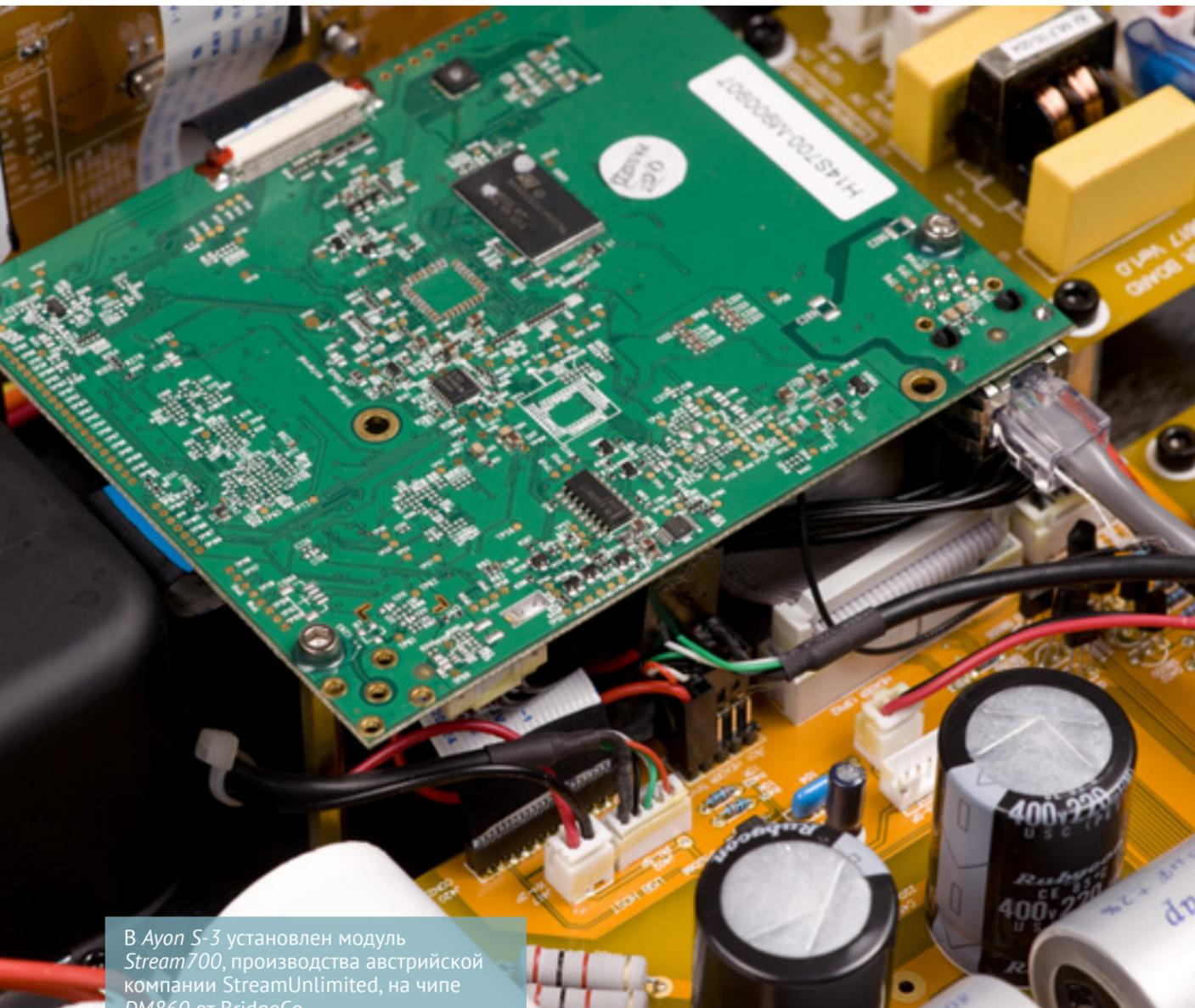
В Ayon S-3 установлен модуль Stream700, производства австрийской компании StreamUnlimited, на чипе DM860 от BridgeCo.
